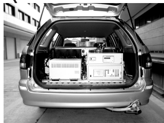
従来の大型システムと同じ性能を持つ、車載型の排ガス計測システム。
